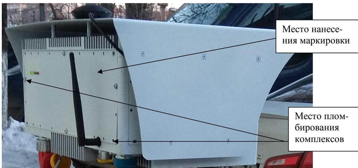
Рисунок 3 - Места пломбирования и нанесения знака утверждения типа
