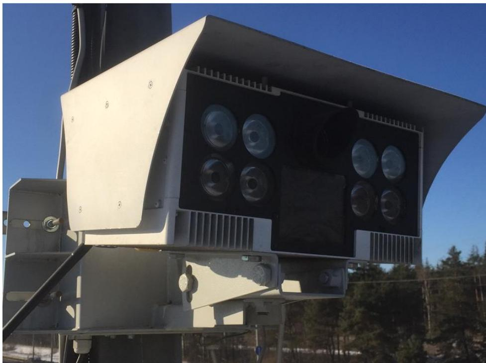
Рисунок 1 – Общий вид комплексов в модификации «Лидер»-С с кронштейном со встроенным блоком питания.
