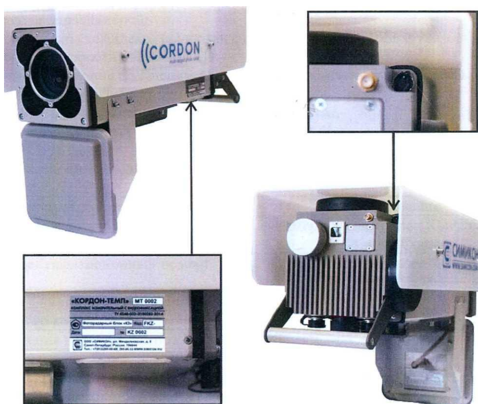
Рисунок 2 - Комплекс «КОРДОН-Темп» на базе блока «К3»
