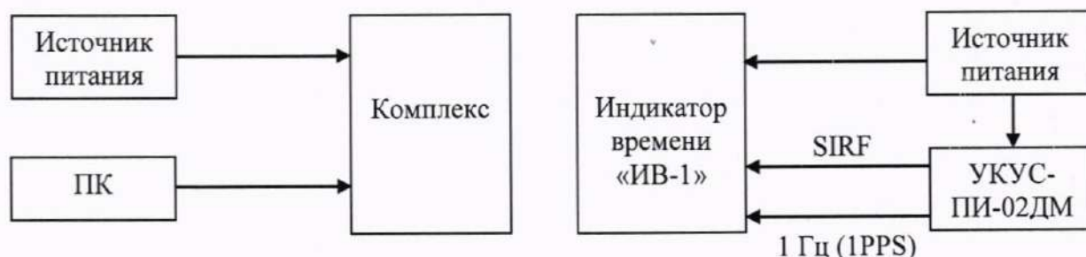
Рисунок 1 – Схема проведения измерений
