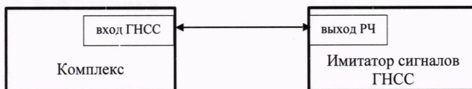
Рисунок 1. Схема подключения имитатора ГНСС к комплексу
