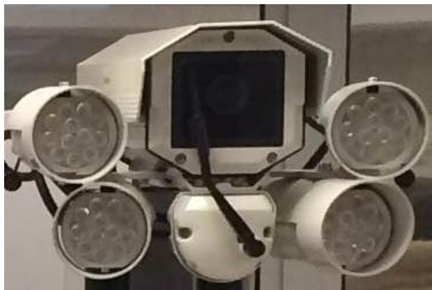
Рисунок 2 -общий вид комплекса (видео модуль с модулями ИК подсветки и модулем очистки)
