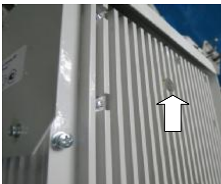
Рисунок 3 – схема пломбировки модуля радиолокационного измерения скорости
