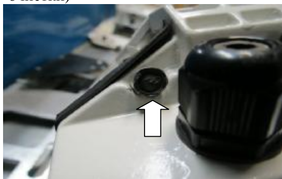
Рисунок 4 – схема пломбировки видео модуля
