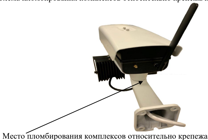
Рисунок 3 – Схема пломбирования комплексов относительно крепежа
