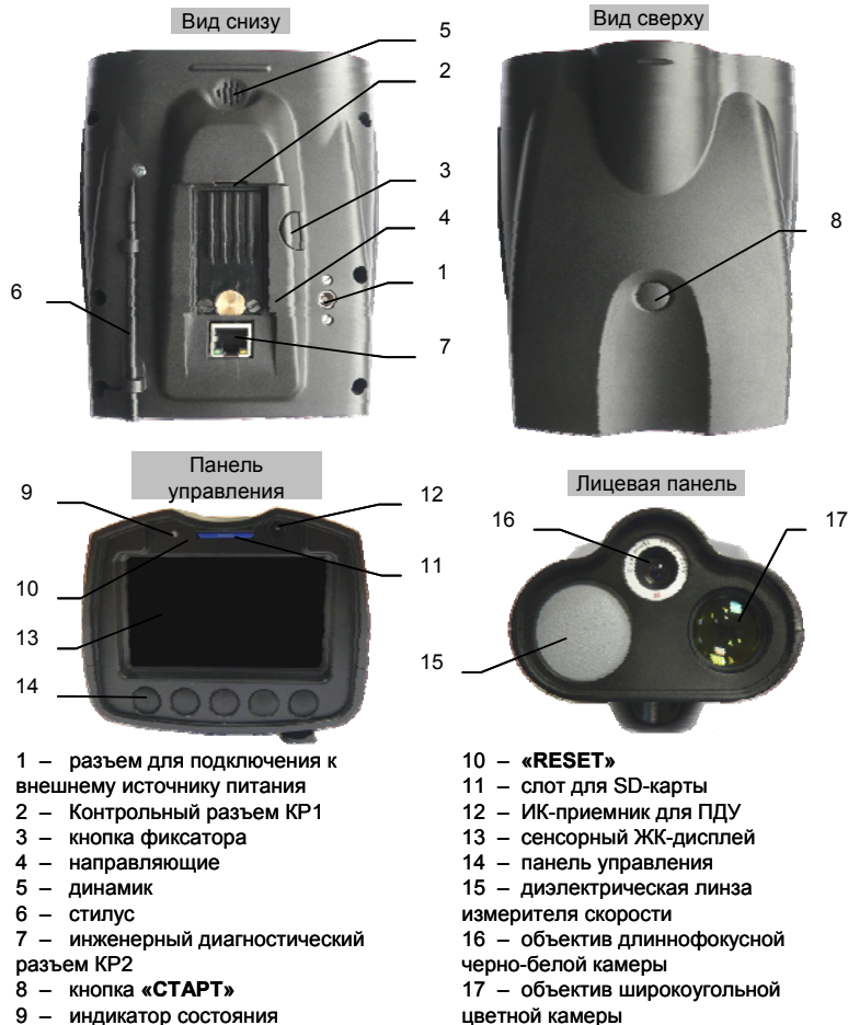
Рис. 2. Конструкция измерительного блока
