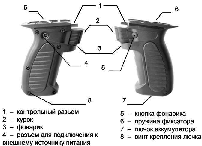
Рис. 3. Устройство рукоятки
