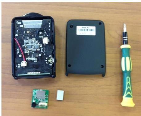
2. Отсоединяем проводки
