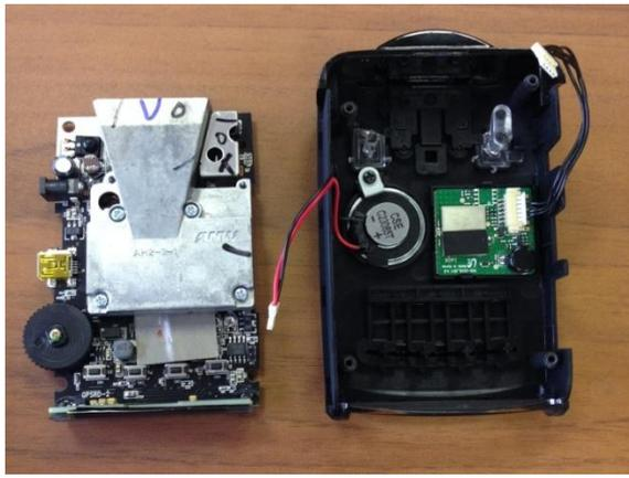
4. Соответственно, слева - для соединения рупора и абсорбера (№4) используем проводящую ленту №3. Справа - и Извлекаем старый чип, на его место ставим новый (№1) с закрепленной на нем уплотнительной прокладкой (№2) , проводок закрепляем на место на новом чипе.
