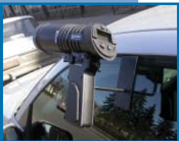
Фото 27 Крепление радара с помощью кронштейна
