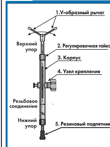
Схема 3 Устройство штатива
