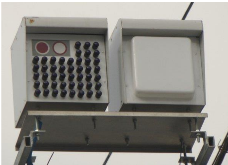
Рис. 5. Примерный вид муляжа радара «Стрелка СТ»
