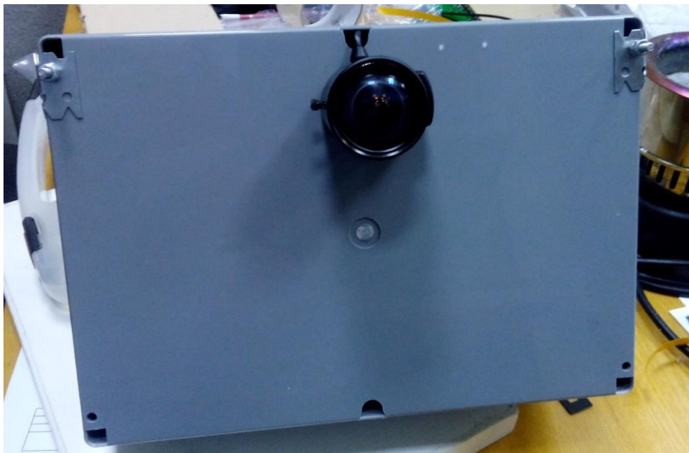
Рис. 10. Внешний вид муляжа радара «Циклоп» с креплением на столб.
