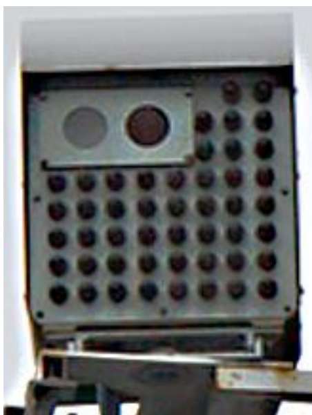
Рис. 4. ИК прожектор (активный) подсветки Стрелка СТ. В темноте мигает светодиодами, имитируя полноценную работу.
