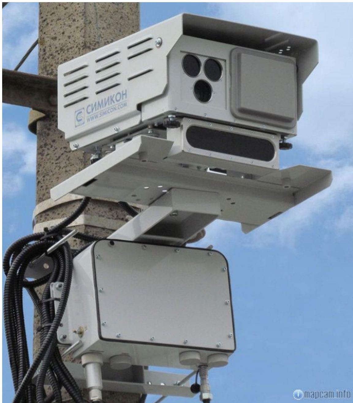
Рис. 8. Примерный внешний вид стационарного варианта муляжа радара «Кордон»
