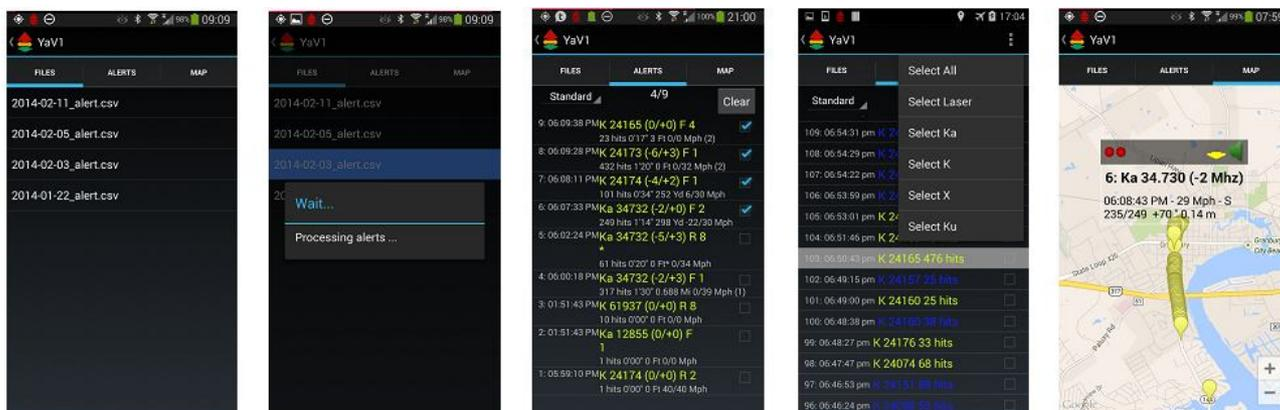
1 . Зарегистрированные тревоги отображаются на карте Google Map с деталями – начало приема сигнала, максимальный уровень, переключение стрелки направления, пропадание сигнала. Каждая тревога формируется из многих сигналов со сходными параметрами, т.е. при обнаружении нескольких сигналов в диапазоне К 24130 +/- 6 МГц , они будут сгруппированы в ОДНУ тревогу от ОДНОГО источника, несмотря на обнаружение большого числа сигналов.
