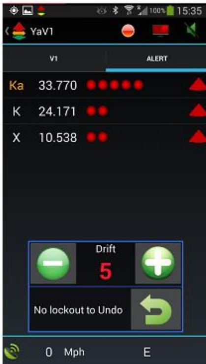
\* Таблица тревог – список обнаруженных источников излучения с указанием диапазона, частоты, мощности и направления на источник сигнала.
