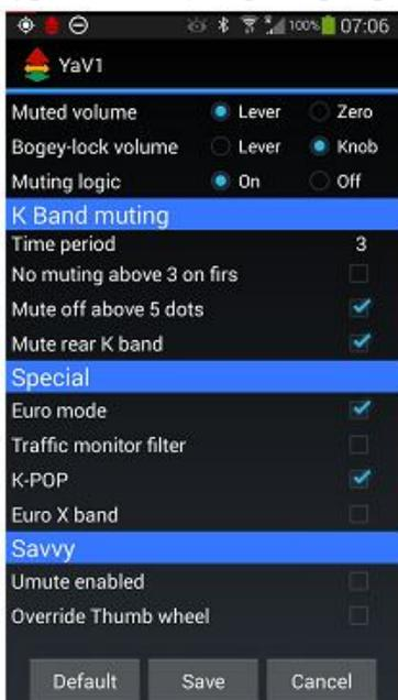
**Mute Rear K band** – (визуальные оповещения никогда не удаляются!) При обнаружении в диапазоне К сигнала сзади и включении стрелки Тыл тревоги не будет (в Ка тревоги с тыла останутся), в результате чего будет отфильтровано почти половина помех. Однако при этом остерегайтесь пропуска радаров, работающих вдгон.
