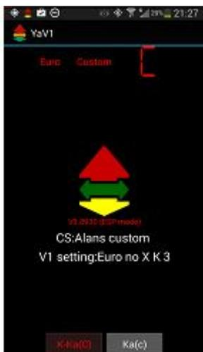
\* На втором скриншоте – соединение с V1 установлено, включен режим Euro mode C, белым шрифтом выведен профиль пользователя с установками V1. Для фильтрации выбран диапазон К-Ка
