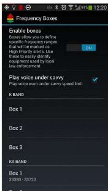
**Enable Boxes** (фильтры) - при включении позволяет выбирать приоритет частоты для каждой тревоги, установив границы полосы ее частот в соответствующем фильтре выбора (box). Можно выбрать частоты, которые не являются важными (box3) или выделить наиболее опасные (box1).
