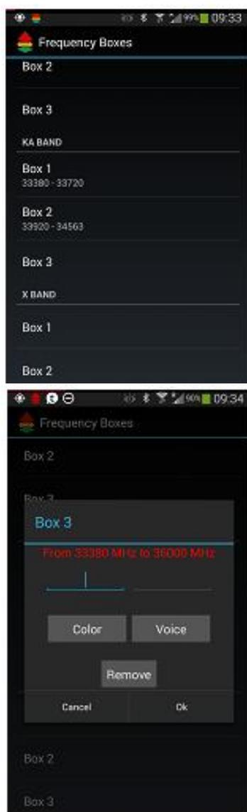
Полоса 33.8 не исключается, но для Euro mode эту полосу лучше исключить для обнаружения V1 импульсных (POP) сигналов. Можно попробовать заглушить часть полосы частот в фильтре выбора, чтобы V1 не выдавал ложные тревоги. В полосе 33,8+/-0,1ГГц могут работать излучатели маскирующих помех, поэтому целесообразно запретить сканирование диапазона 33,7-33,9.
