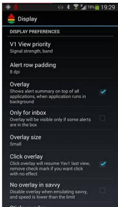
3.) “In box, Signal Strength, Band”(выбор, уровень, диапазон) – означает, что сверху будет сигнал, установленный в фильтре выбора, затем наиболее мощный сигнал, затем в соответствии с порядком диапазонов.
