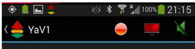
\* Иконка YaV1 вверху слева: разноцветная – соединение с V1C установлено и YaV1 подключен; красная - нет подключения.
