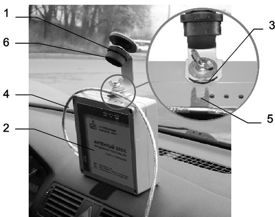
**Рис. 16. Положение АБ МП в патрульном автомобиле**
