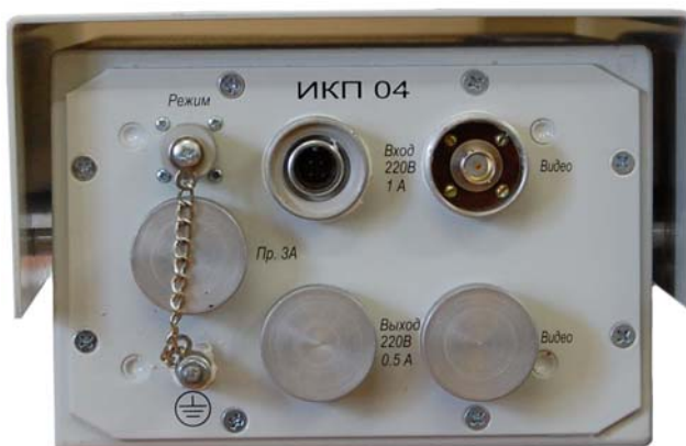
Рис.8.2 Инфракрасный прожектор. Вид со стороны панели коммутации.
