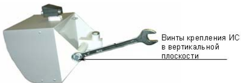
Рис. 7.8 Юстировка ИС в вертикальной плоскости.
