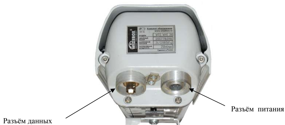
Рис. 8.3 Теледатчик. Вид со стороны разъёмов.
